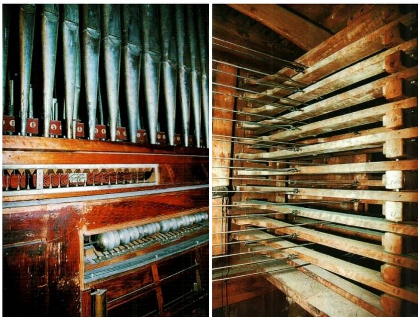
Sous les tuyaux de façade, la laye ouverte avec les soupapes, et plus bas les campanelli. (Cliché © Raphaël Sant)
