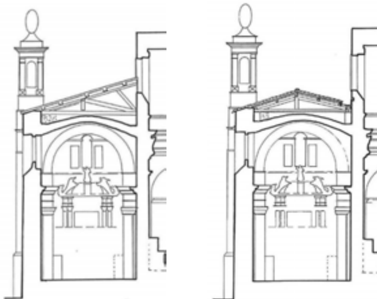
Coupes sur la chapelle avant et après réfection de la toiture en 1998. Le haut de l'ancienne toiture en appentis passait en travers de la baie du transept sud. (J-C Yarmola / DRAC PACA)
