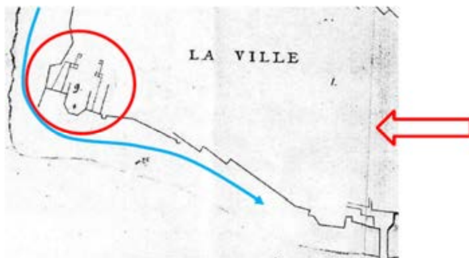
Extrait du plan des fortifications de Breil, dressé par de La Berrie, daté de 1692. (Col. ADAM). L'église Santa-Maria in Albis et la chapelle de la Miséricorde, apparaissent en chantier. Leurs façades principales à l'est ne sont pas réalisées. Leurs chevets sont insérés dans le mur-rempart qui cerne le village le long de la Roya. Une digue détourne les eaux de leurs fondations.
