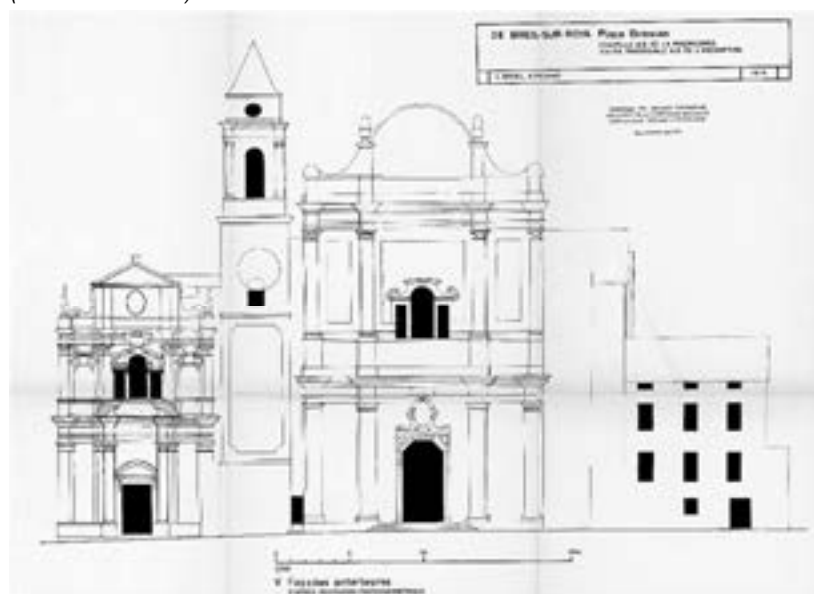
Élévation de la façade est de l'église Santa-Maria in Albis, encadrée par la chapelle de la Miséricorde et un immeuble élevé sur un ancien moulin, G. Bruel et N. Pegand. (Col. DRAC PACA)
